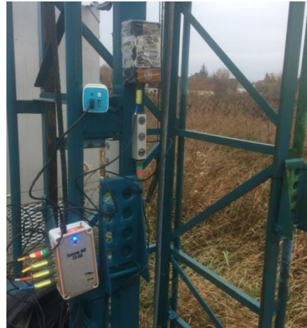
Рис. 6. Мачта анемометра, оборудованная вибродатчиками
