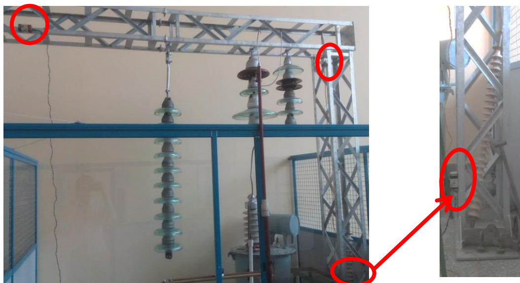
Рис.4. Общий вид пространственной модели, оборудованная вибродатчиками--акселерометрами
