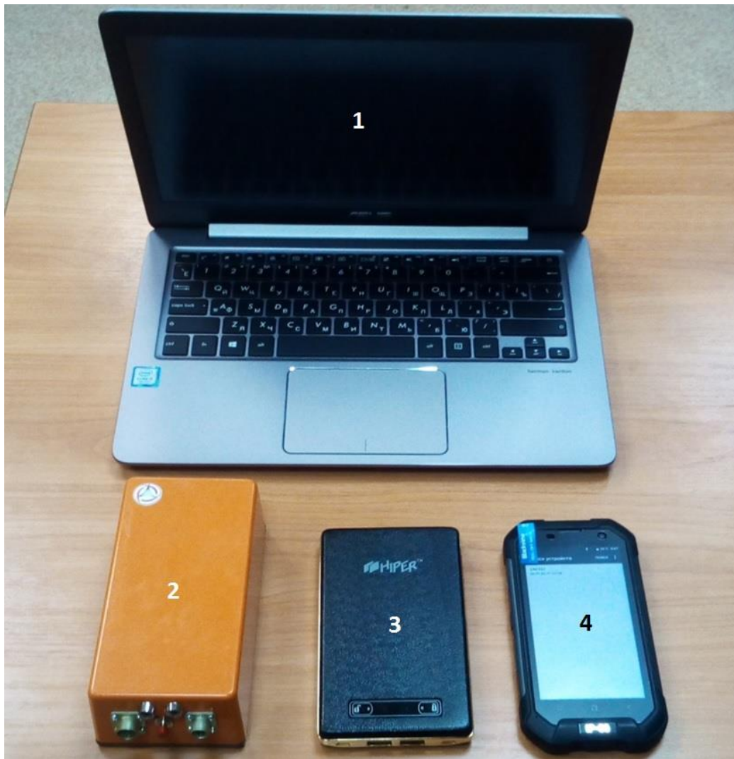
Рис. 12. Общий вид комплекса для оценки технического состояния опор
