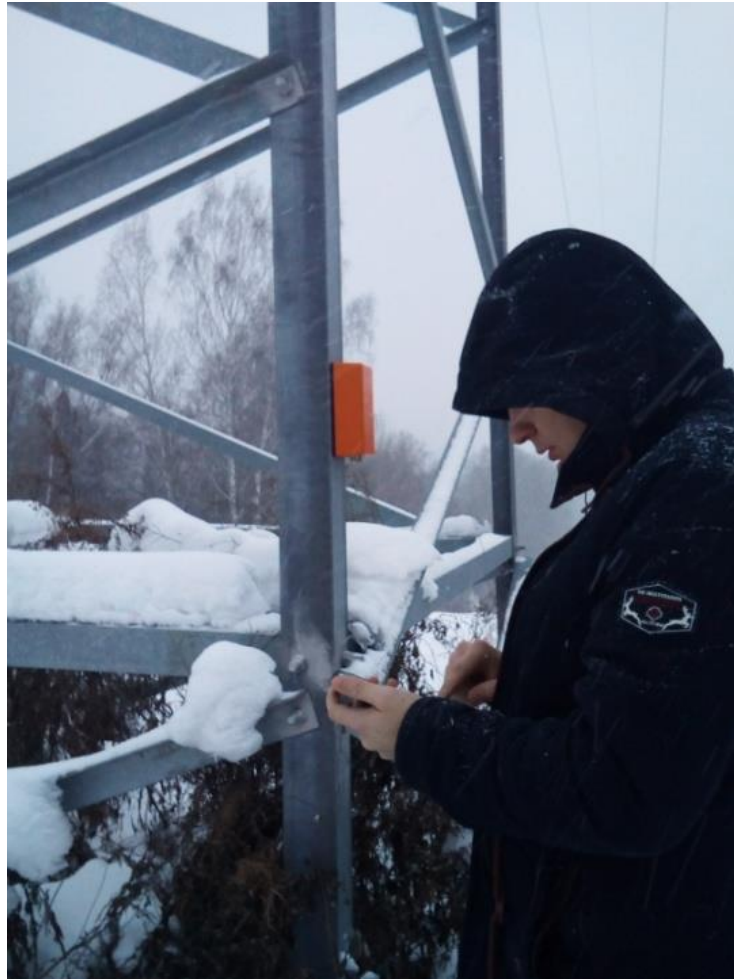
Рис.11 Работа с измерительным комплексом «ЛЭПтон» и смартфоном
